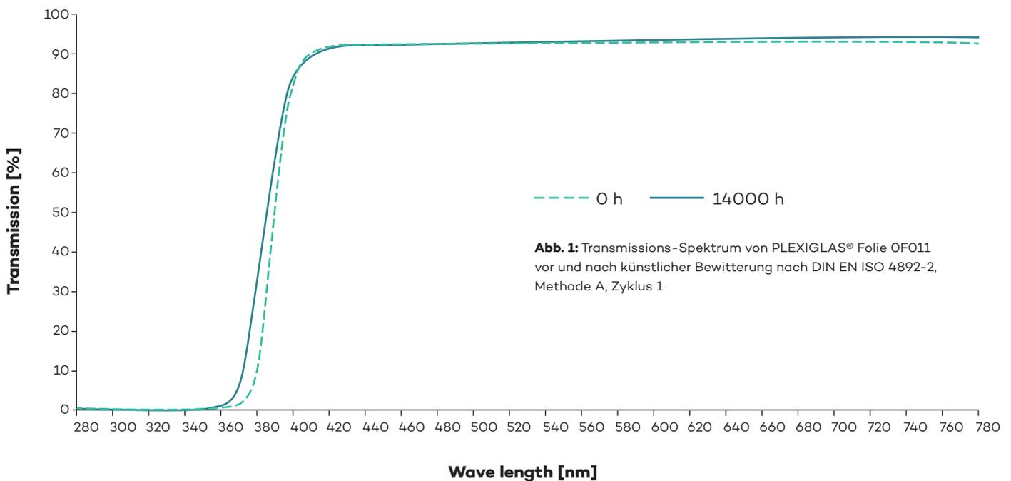
**Abb. 1:** Transmissions-Spektrum von PLEXIGLAS® Folie OF011 vor und nach künstlicher Bewitterung nach DIN EN ISO 4892-2, Methode A, Zyklus 1
